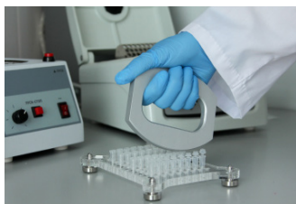
СТ-14 “Амплипресс” – приспособление для эффективного прижима крышек пробирок объемом 0,2 мл
